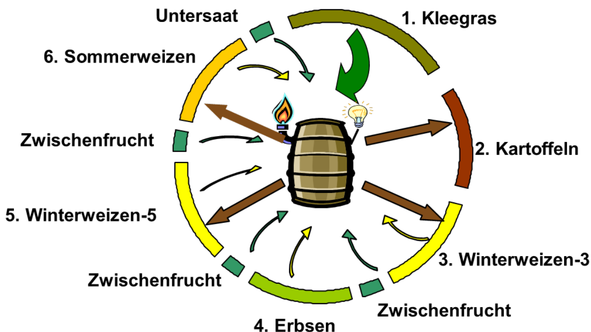
Abbildung 1: Integration der Biogastechnologie in den Ökolandbau; Pflanzenbauliche Reststoffe werden zur Vergärung geerntet, Gärreste können zum optimalen Zeitpunkt zu den benötigten Kulturen gedüngt werden.
